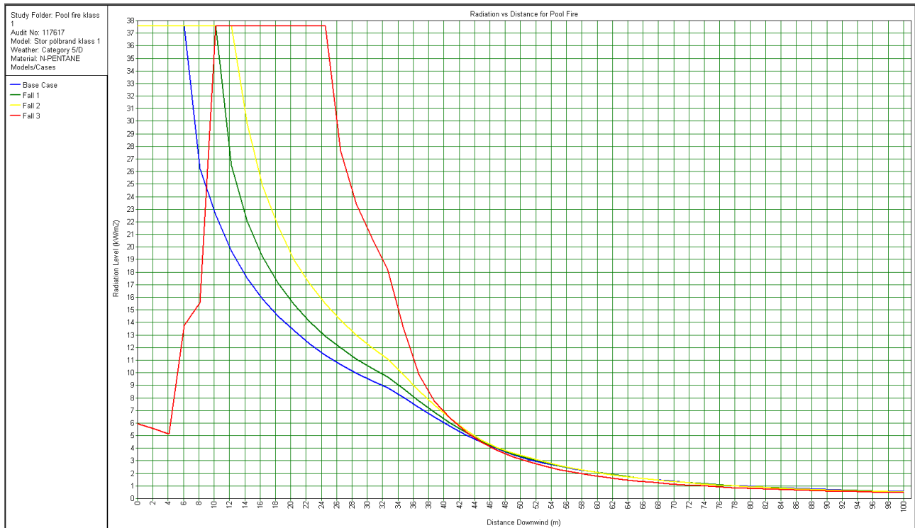
Figur B.5. Strålningsnivå i kW/m 2 på olika höjd över mark som funktion av avstånd. Brandscenario; pölbrand 200 m 2 , bensin, vind 5 m/s. De olika fallen beskriver strålningen på olika höjd över marken (Base Case= 0 m, Fall 1=2 m, Fall 2=5 m och Fall 3=15 m). Not: Avstånd (x-axel) räknas från centrum av pöl
